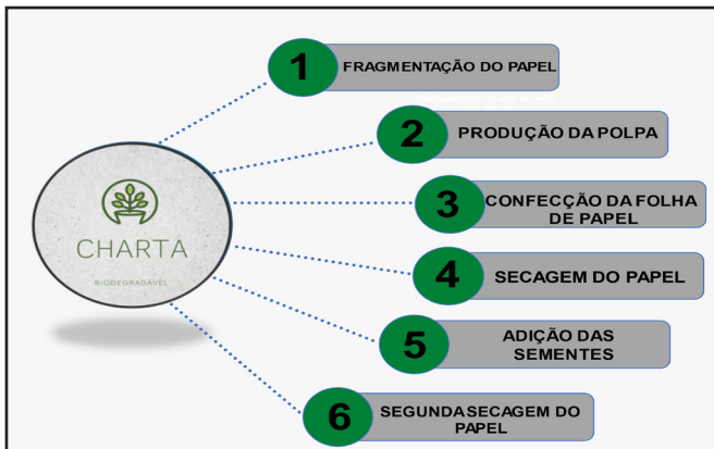
Figura 1 - Etapas para a obtenção do papel semente
