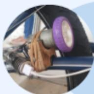
**Por fim, fixe bem o circuito à bicicleta e conecte o cabo USB de seu dispositivo móvel a entrada do seu carregador sustentável.**
